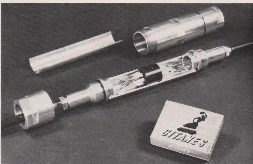
Fig. 8 B. - Connecteurs « multifibres » (Corning / câbles de Lyon).
