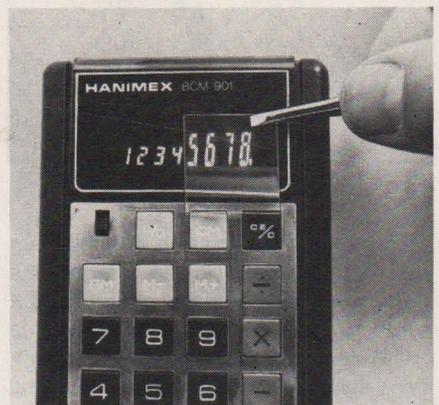
Ce film permet notamment de réduire les coûts de production qu'entraînait la création de systèmes de diffusion de lumière prémoulés pour les luminaires par exemple.
