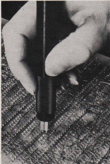
isolant, les croisements de fils ne posent pas de problème. Les cartes imprimées ne comportent que des pastilles, sur lesquelles viennent se souder les composants et les fils, et peuvent donc être facilement standardisées. Un dépôt d'étain-plomb permet le soudage par refusion sans apport de soudure lors du câblage. Les machines utilisées pour ces opérations de câblage vont de l'outil manuel du maquettiste (EMASOUD) jusqu'à la machine semi-automatique à commande numérique (EMAXY).
